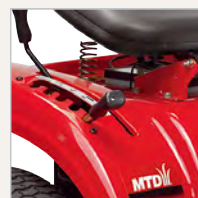
NASTAVENÍ VÝŠKY SEČENÍ & OVLÁDACÍ PÁKA SPUŠTĚNÍ SEKAČKY
